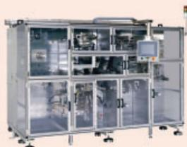
リチウムイオン電池用巻回システム
