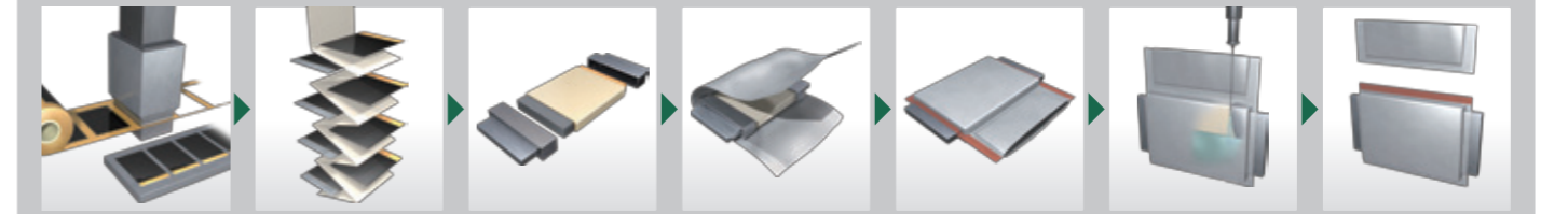
7 电极模切 用模具将正极板·负极板冲切成规定的大小。 8 叠片 高速、高精度地交互堆叠电极和隔膜。 9 极耳焊接 将连接端子(极耳)焊接，以输入输出电力。 10 包装 用外装材料包住电极堆叠体。 11 热封 加热粘合电芯的3个方向。 12 注入电解液 往电池电芯中注入电解液。 13 脱气·密封 排出内部的多余气体，热压密封电池电芯。
