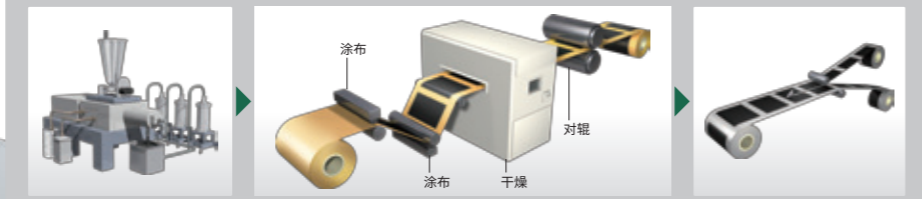
4 计量·搅拌 称量正极·负极材料的正确量，混合各种材料制成膏状。 5 涂布·烘干·对辊 将电极材料均匀涂布到金属箔片上，通过热风喷射和急速抽吸湿气将涂布的电极材料高速烘干，用辊子轧制电极提高密度。 6 切片 将电极材料及隔膜卷切割成合适的大小
