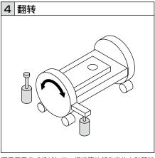
可用于已完成机械加工、焊接等的部件类的自动翻转 机构。减少驱动器、齿轮、小齿轮类等驱动部的磨损, 延长寿命。
