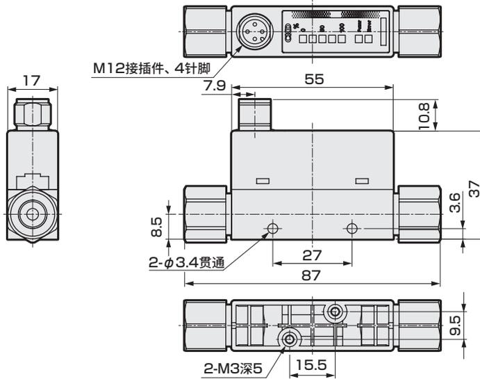
配管口径：直管型 1/4英寸双卡套接头
