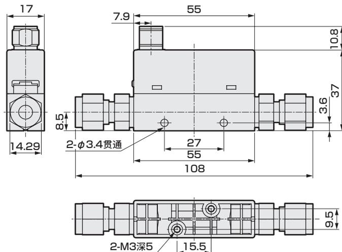
配管口径：直管型 1/4英寸JXR外螺纹接头
