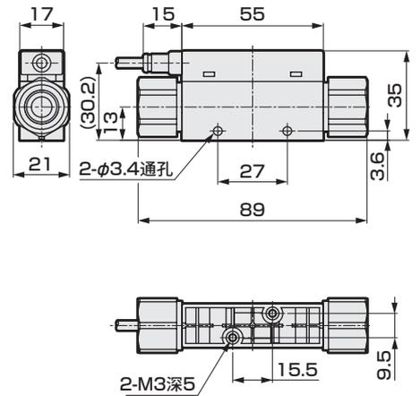
配管口径：直管型 1/4英寸双卡套接头
