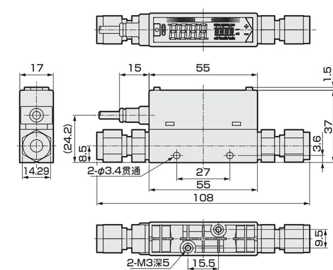
配管口径：直管型 1/4英寸JXR外螺纹接头
