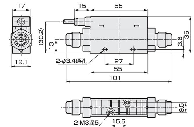
配管口径：直管型 Rc1/2、G1/2、NPT1/2
