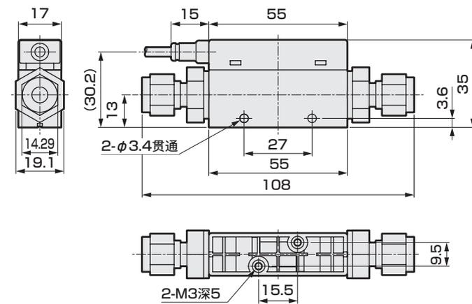
配管口径：直管型 1/4英寸JXR外螺纹接头
