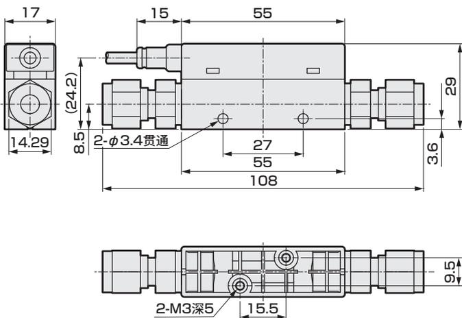
配管口径：直管型 1/4英寸JXR外螺纹接头
