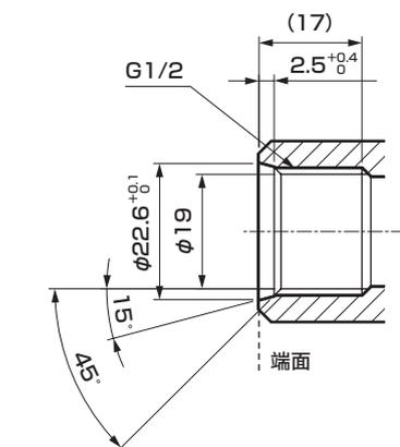
15°的面为密封面。并非端面密封，敬请注意。此外，使用前也请一并确认接头的螺纹深度。
