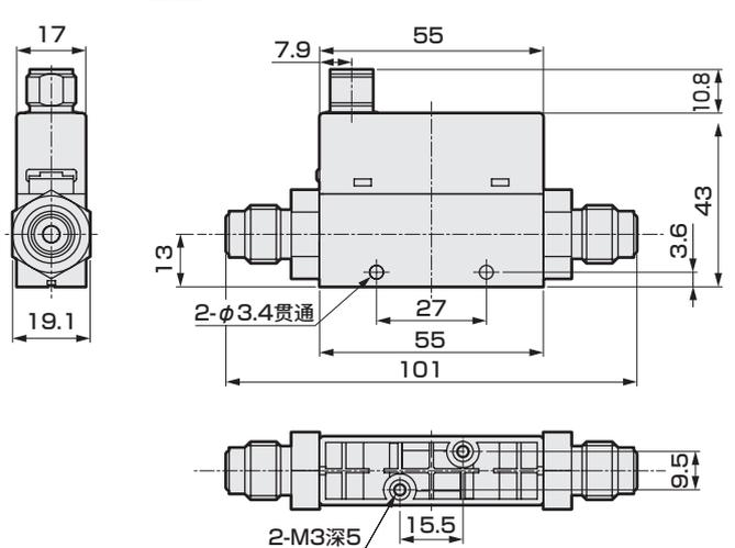
配管口径：直管型 Rc1/2、G1/2、NPT1/2
