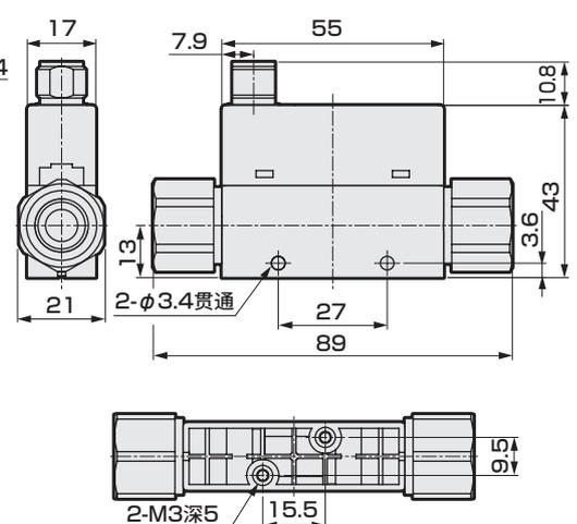
配管口径：直管型 1/4英寸双卡套接头
