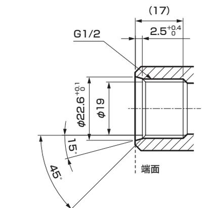
15°的面为密封面。并非端面密封，敬请注意。此外，使用前也请一并确认接头的螺纹深度。
