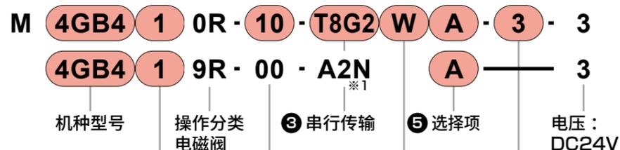
① 切换位置分类    ② 配管口径    ④ 端子、接插件针脚排列方式    ⑥ 连数
