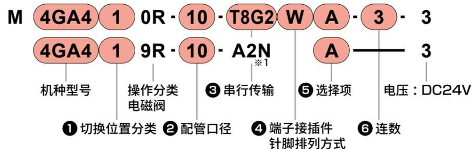
※1：“A2N”表示A形(向下)接插件、带指示灯、浪涌吸收器、无导线。
