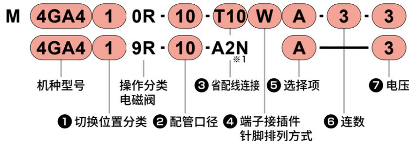
※1：“A2N”表示A形(向下)接插件、带指示灯、浪涌吸收器、无导线。
