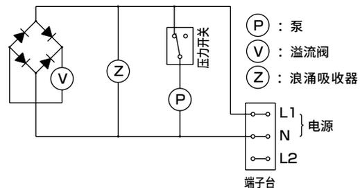
※压力开关的触点表示阀关闭时。
