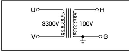
变压器的二次侧必须单侧接地，以明确高电位侧(H)和接地侧(G)。
