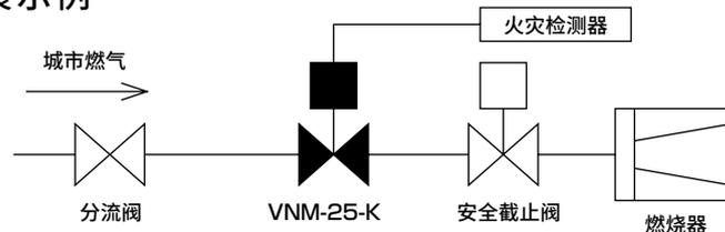
本产品作为双重截止的上游侧的安全截止阀使用，通过与火灾探测器连接，在发生火灾时与火灾探测器联动以截止燃气，可以将燃气泄漏引起的火灾扩散抑制在小范围内。
