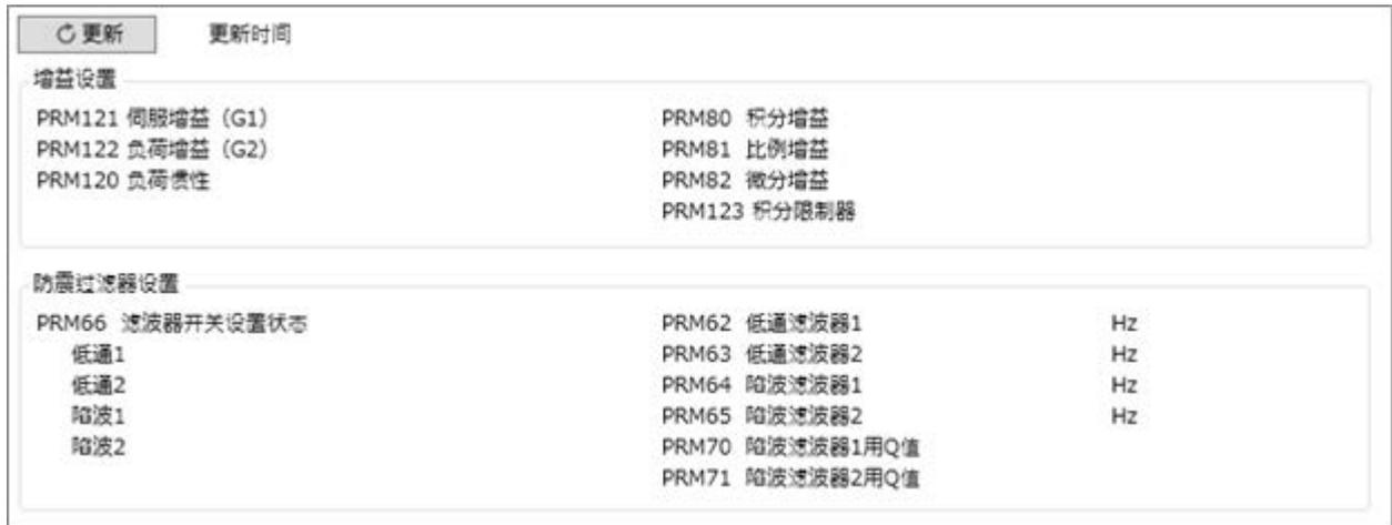
如果点击[更新]按钮，则显示连接着的驱动装置的增益设置、防震过滤器设置相关的设置内容。
