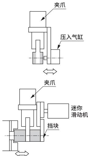
(注)由于工件在小爪上滑动,夹爪寿命可能会大幅降低。小爪的形状需要充分考虑。
