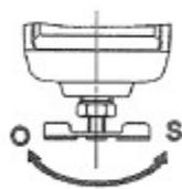
将旋钮向 O 侧旋转时排水，向 S 方向旋转时停止排出。
