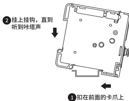
8. 压紧直至模块间无间隙后，关闭并连上连接挂钩弹簧**F**与连接挂钩板**G**。
