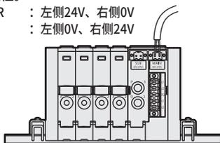
从站(电装·供排气模块)为2台以上时，请将电源线输入到第1个MAIN中，然后输入到由SUB构成的MAIN中。
