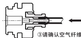
③请确认空气纤维管通过衬圈正常插入后再作业。
