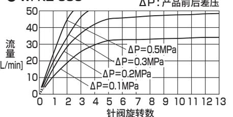
\*针阀即使在旋转数0(全闭)的状态下也会发生内部泄漏。
