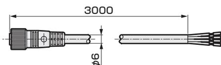
成品外径6mm、芯线0.5mm<sup>2</sup>、绝缘体外径1.9mm
