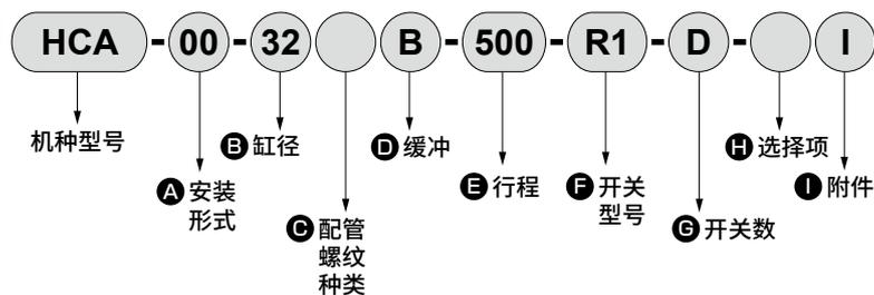
機種型号：高速型气缸
