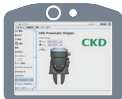
可通过图片显示查看夹爪开关状态的同时，设置数字I/O。
