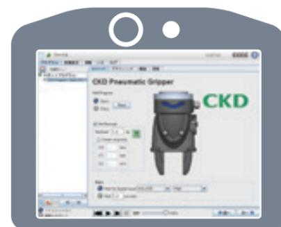
设置夹爪的同时，还可设置机器人工作时所需工具的合计重量(Payload)与重心位置。
