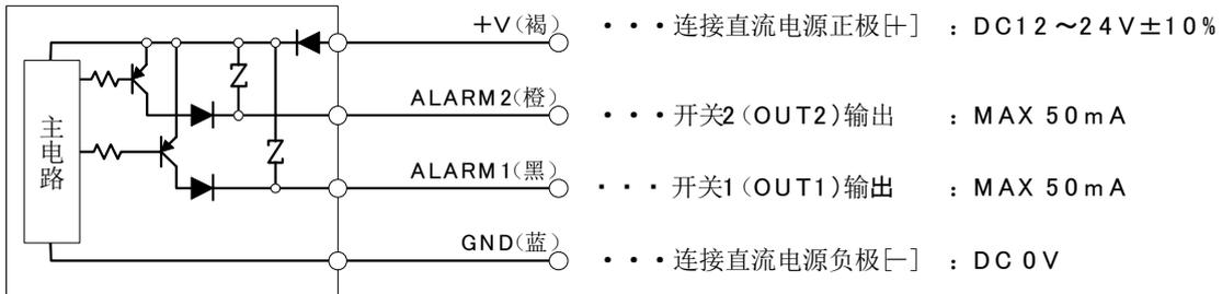
● WFK3 \*\*\*C(传感器型电压输出规格: -A0/-A2/-A3, 开关型NPN输出规格: N0/N1)
