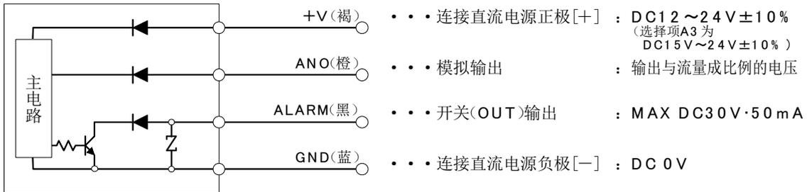
● WFK3 \*\*\*C(传感器型电流输出规格: -A1, 开关型NPN输出规格: N0,N1)
