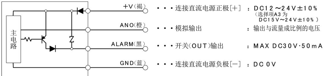
● WFK3 \*\*\*C(传感器型电流输出规格: -A1, 开关型PNP输出规格: P0,P1)
