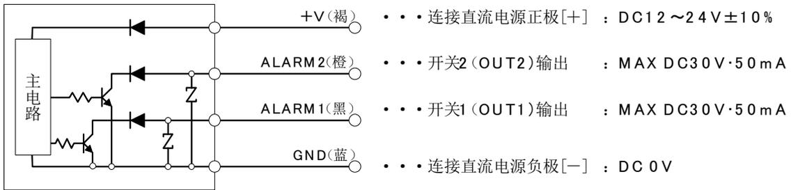
● WFK3 \*\*\*M(开关型PNP输出规格: -P0/-P1)
