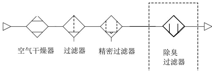
使用水润滑方式的空气压缩回路时，要避免氯酸物质混入压缩空气。
