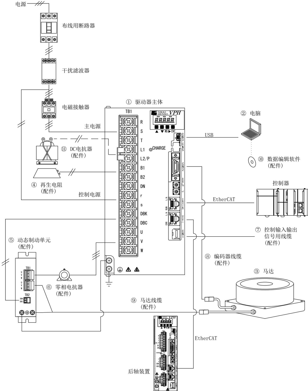
图1-2 1.5kW级以上VPH HD类型 系统构成
