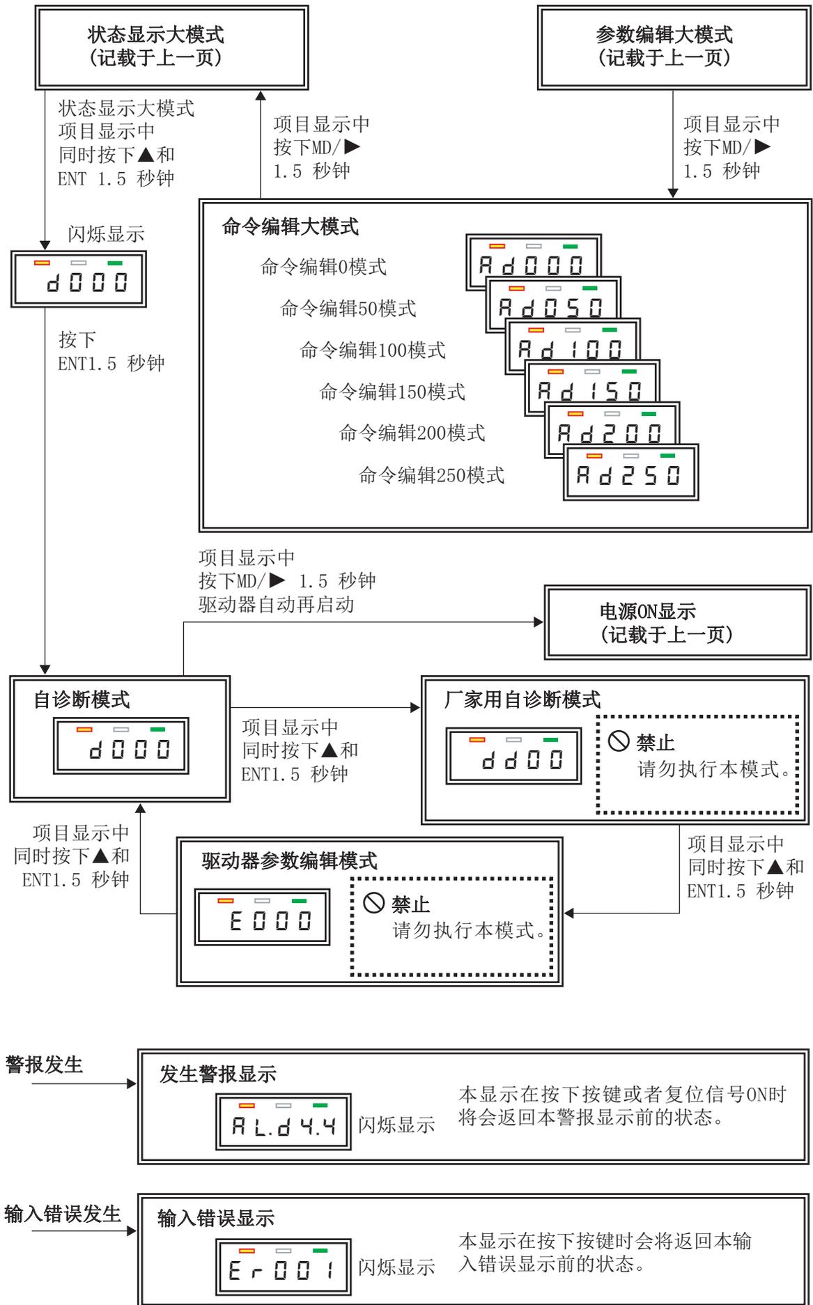
图12-3 操作模式的构成和转变 (2/2)
