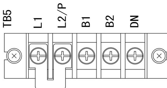
未使用 DC 电抗器时，请勿拆除 L1 — L2/P 间的短路条。
