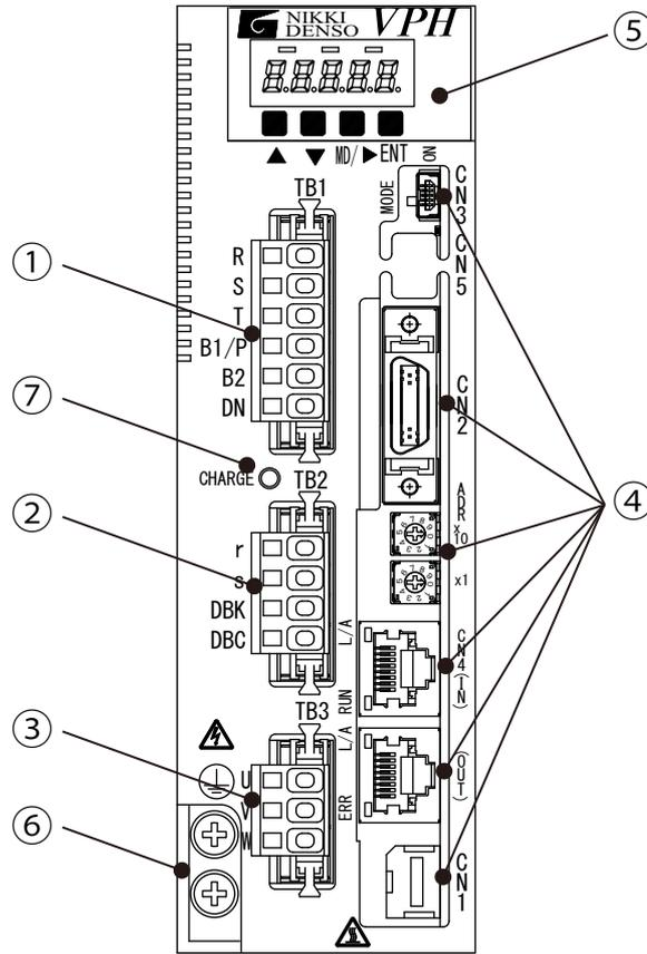
图13-2 400W以下的驱动器主体正面图 (Type1)
