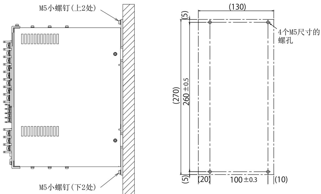
图2-5 驱动器的安装方法 (3.3kW)
