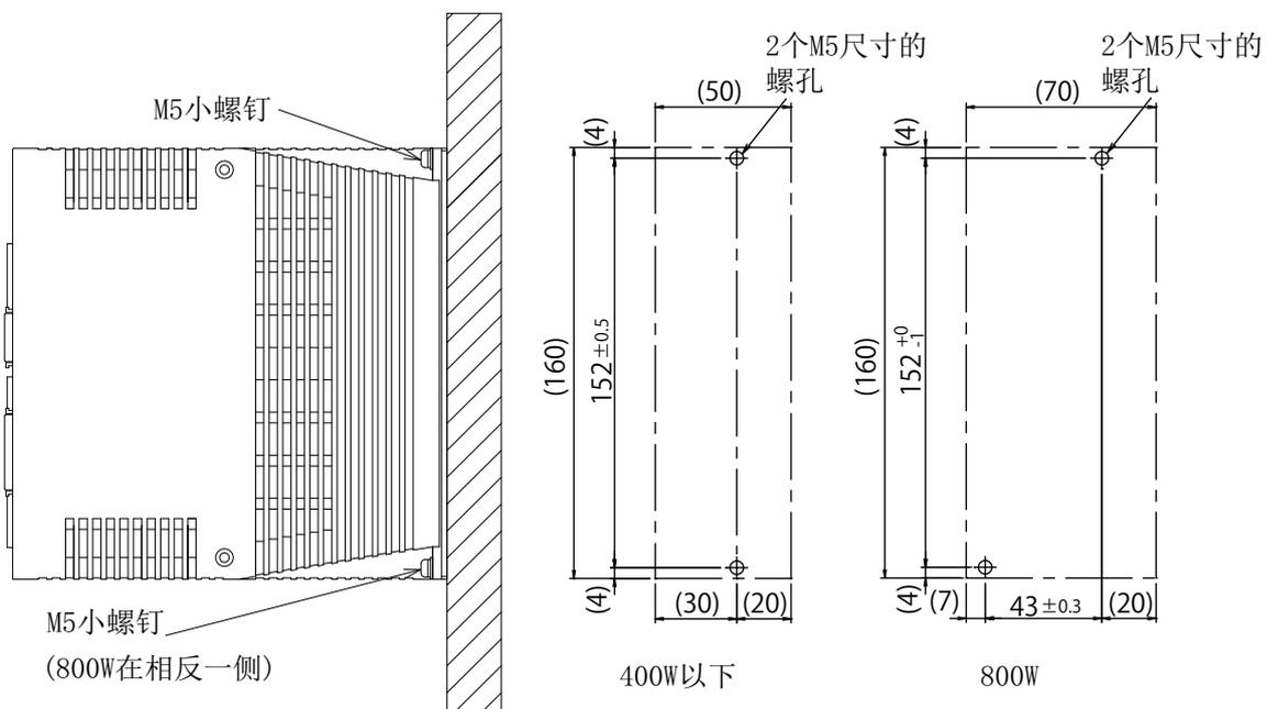
图2-3 驱动器的安装方法（800W以下）
