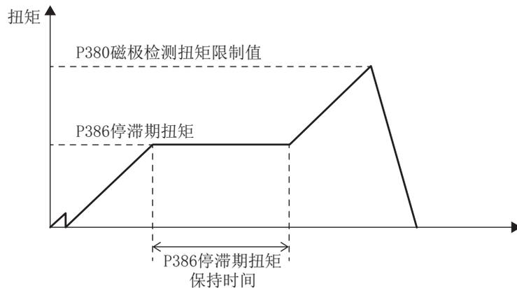
图6-1 自动磁极检测 1次量的样式动作
