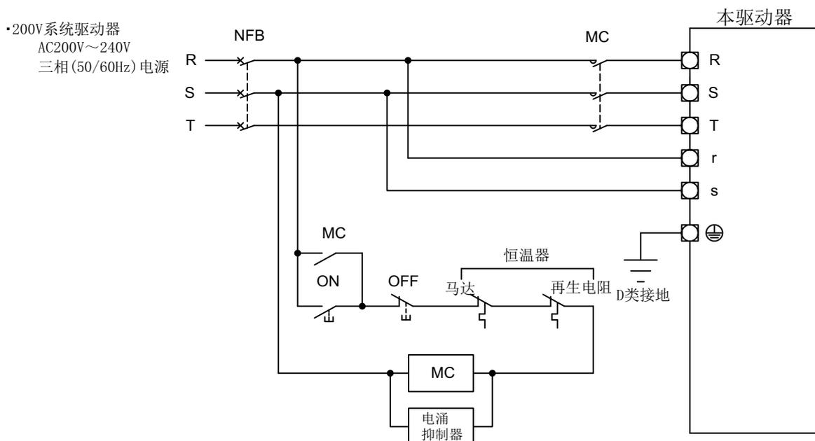
图2-8 三相电源时典型的电源电路
