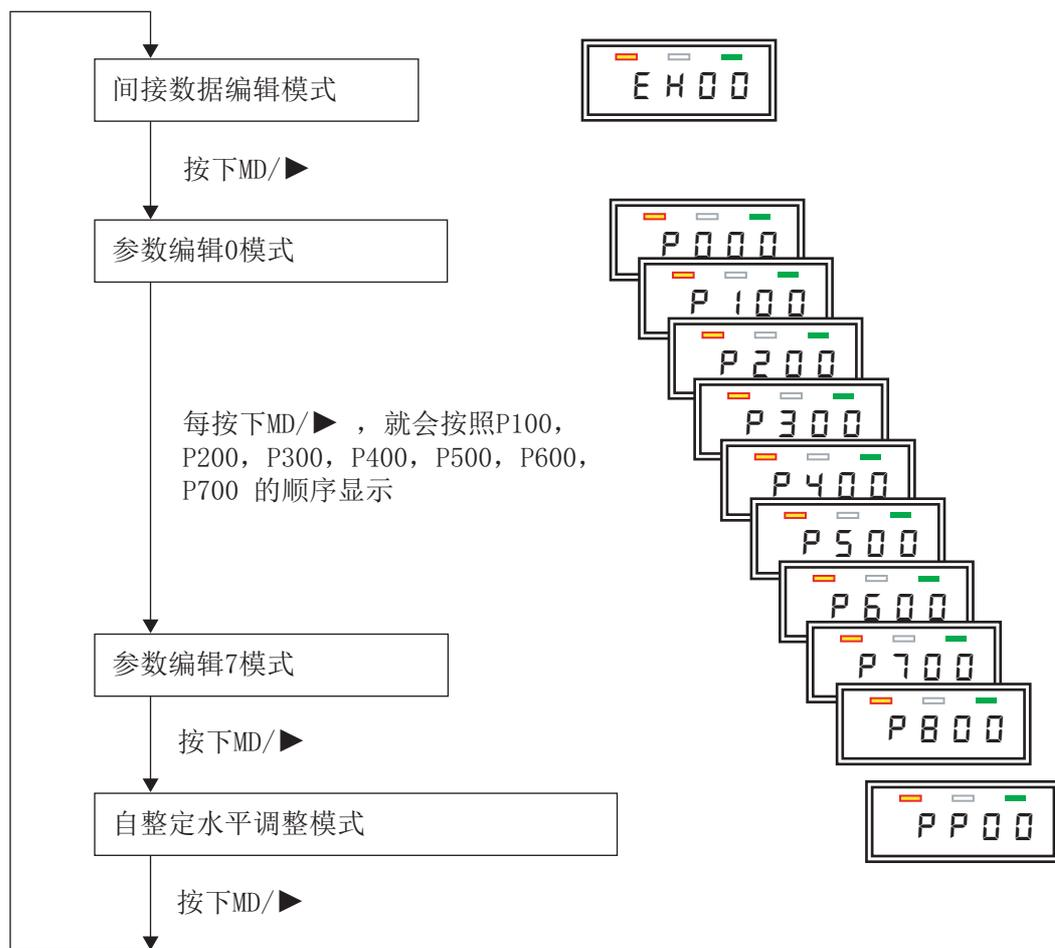
图12-4 参数编辑模式的构成和转变
