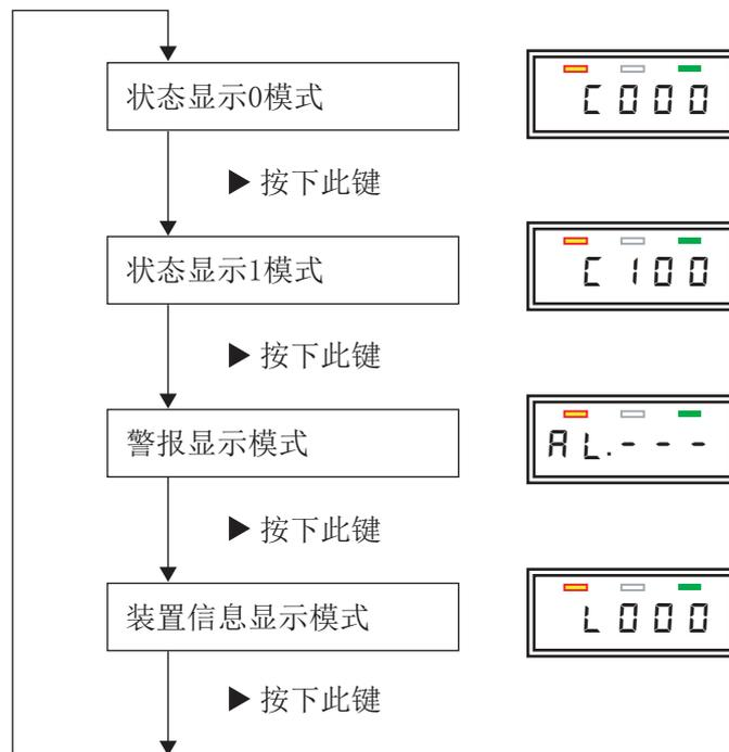
图10-1 状态显示模式的构成和转变
