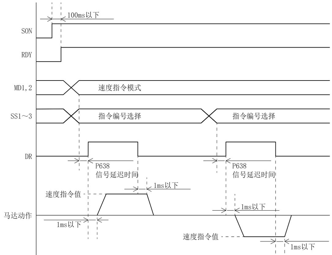
图5-1 内部速度指令时序图
