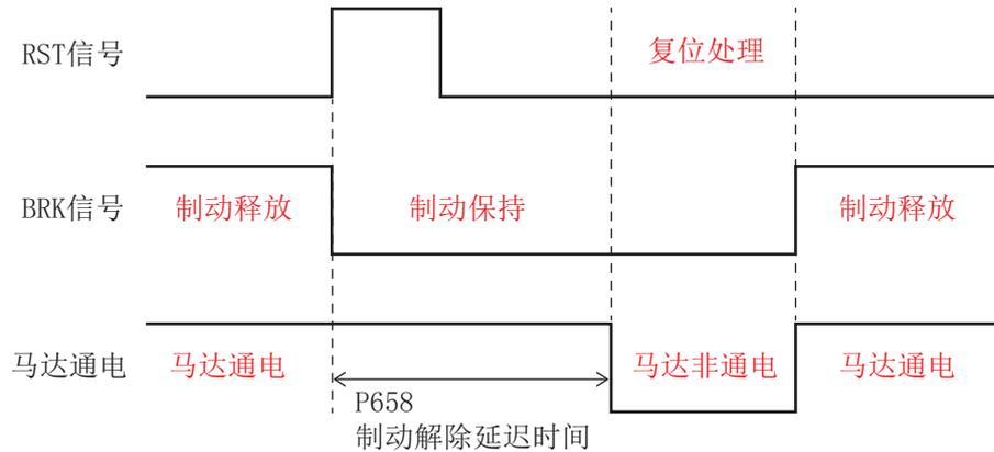
由复位信号 (RST) 的 ON 边缘经过 [P658(第 8 ~ 5 位数)] 的设定时间后, 执行复位处理。
