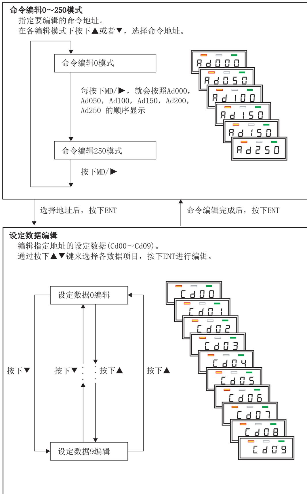
图12-9 命令编辑模式的构成和转变
