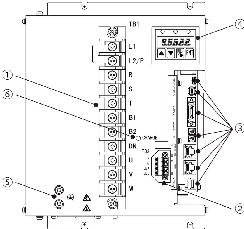
图13-10 7kW驱动器主体正面图 (Type5)
