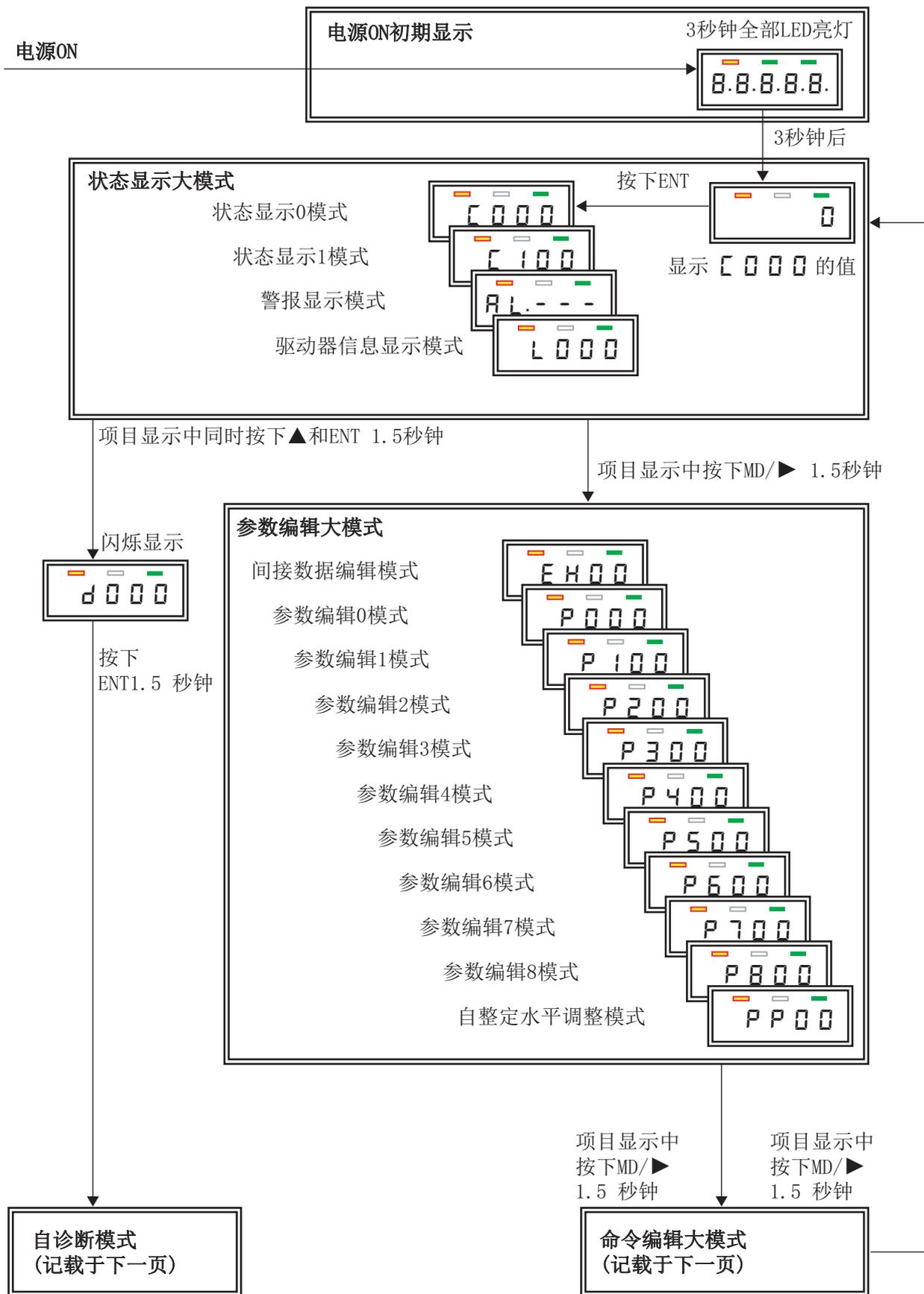
图12-2 操作模式的构成和转变 (1/2)
