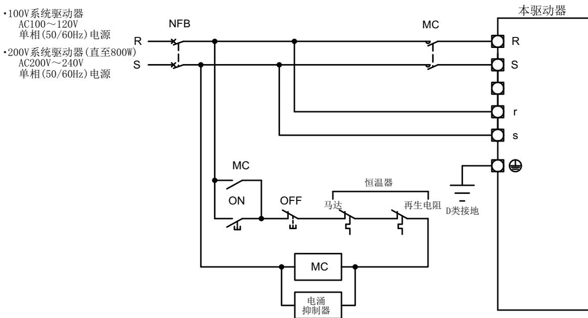
图2-9 单相电源时典型的电源电路
