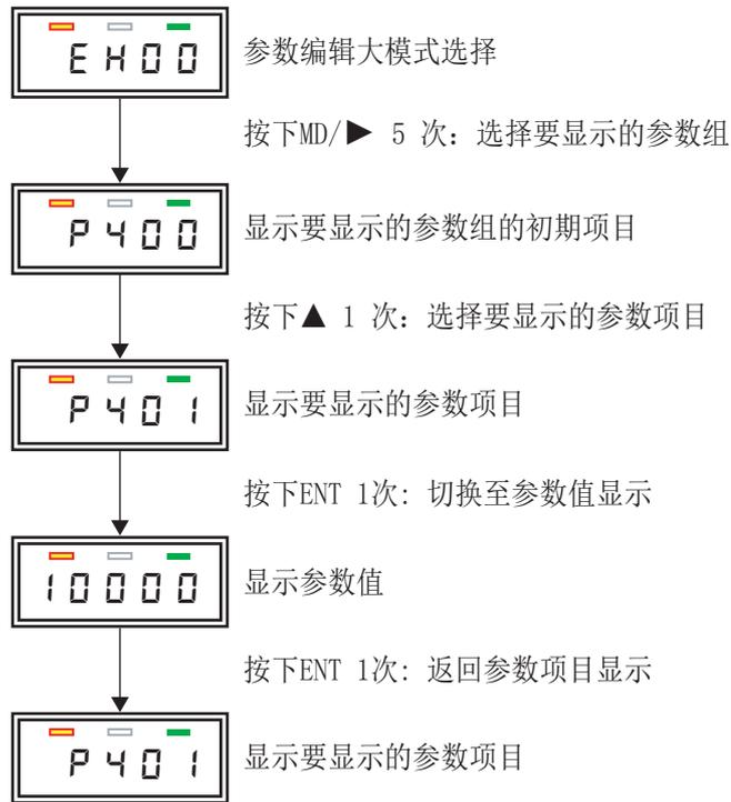
图12-5 P401的数据显示操作例
