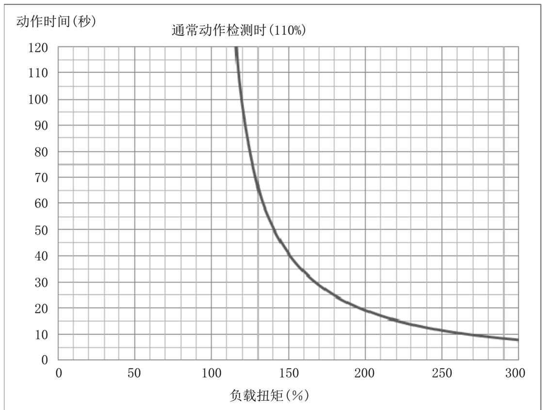
图8-1 负载扭矩与检测时间的关系
