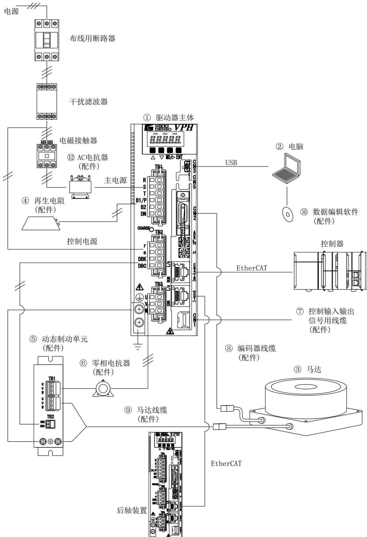
图1-1 800W级以下VPH HD类型 系统构成
