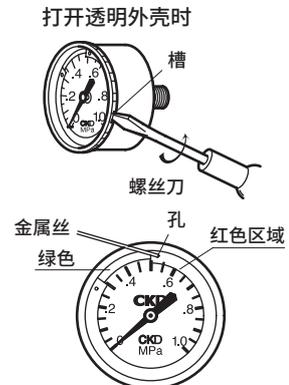
拆下透明外壳，将金属丝插入红色区域的孔中，以移动红色区域。
