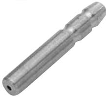
压力表用喷嘴大多为圆形。根据与流出面积的关系，测量距离为 $X \leq \frac{d}{4}$  (d: 检测喷嘴内径、X: 与检测物的距离)，以较短的间隙使用。此外，内径1~2mm (APA4-BA10或APA4-BA20) 最合适。
