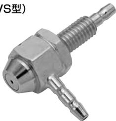
与背压型相同，外周还设计有一层空气层B，使空气形成漩涡进行收束。因此，与背压型相比，内侧的空气更难以扩散，测量距离更长。
