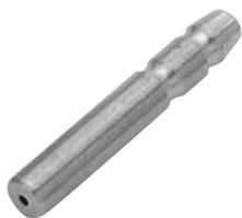
该喷嘴主要用于检测物体的有无，因此与前面介绍的3个喷嘴相比，测量距离变长。使用方法是，使喷射喷嘴B与检测喷嘴A相对，利用喷嘴间有物体时和无物体时的压力变化，检测物体的有无。对于这种类型的喷嘴，检测侧的喷嘴内径一般等于或大于喷出侧的喷嘴内径。
