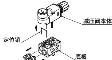
使用一字螺丝刀等工具，拆下从供气模块侧面插入的定位销，以更换供气模块的弹壳型接头。
