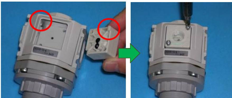
ボディ凹とゲージプラグの凸があうように挿入します。
