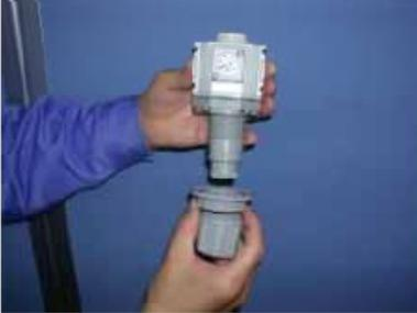
④L形ブラケットの凸とカバーの凹を合わせて挿入し、マウンティングナットを締め込む
