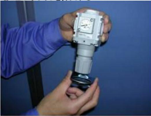
④マウンティングナットを締め込む
