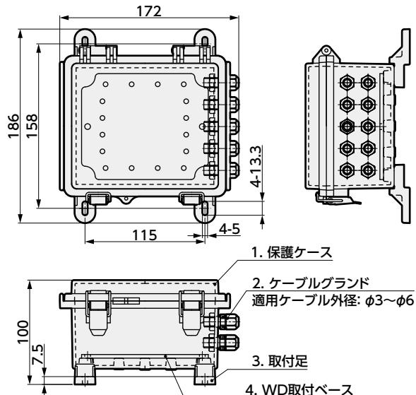
外形図は保護ケースに下記の部品(No.2~4)を取り付けた状態を示しています。
