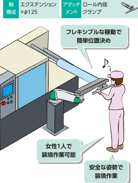
軸構成 エクステンション +φ125 アタッチメント ロール内径 クランプ
