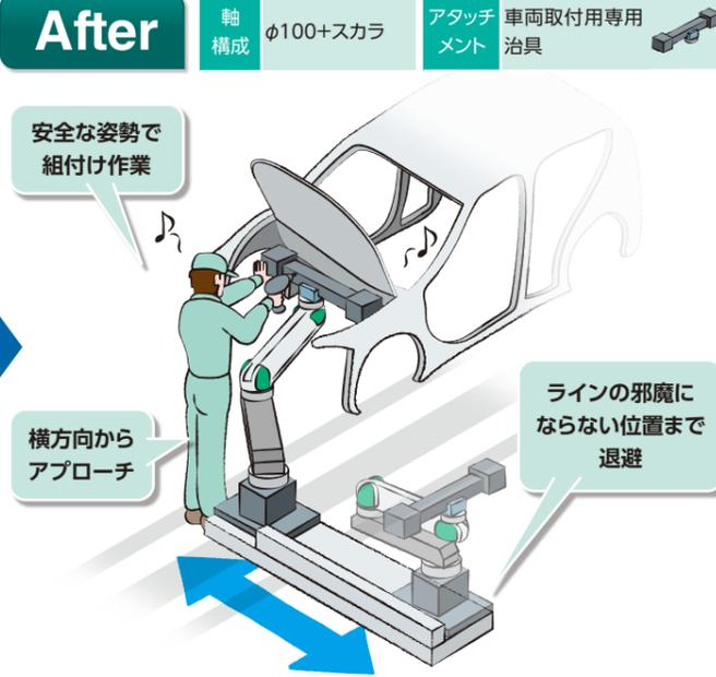
軸構成 φ100+スカラ アタッチメント 車両取付用専用治具
