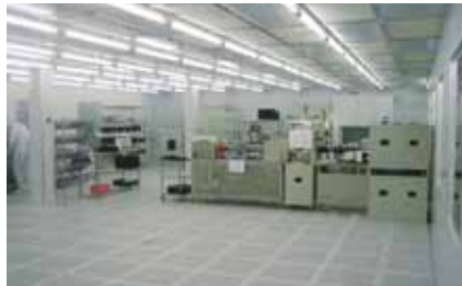
0.3μ基準、クラス100の製品組立用クリーンルーム
