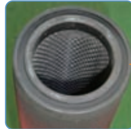
劣化したエレメント
