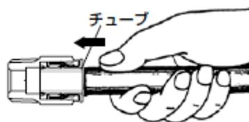
チューブをチューブエンドにあたるまで押し込んでください。チューブが継手から抜けないことを確認してください。
