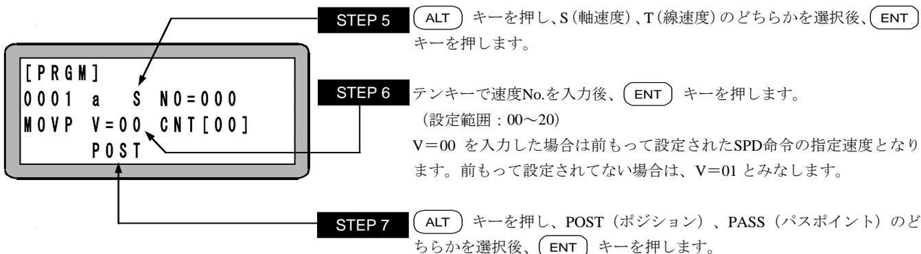
**?** STEP 2～7 の位置にカーソルがある場合は、(F1) キーを押すと、STEP3 で指定した座標テーブルの表示に切り替わり、座標が設定できます。また、元の表示に戻るときは (ESC) キーを押します。
