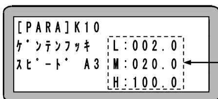
**STEP 1** テンキーでA3 軸の原点復帰速度データを入力し、**ENT** キーを押します。
