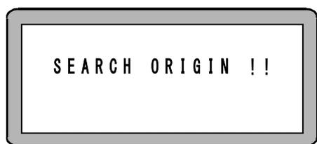
同期軸原点サーチ中は、左記の様なメッセージが画面に表示されます。同期軸原点サーチが完了後、「同期軸原点サーチ」画面に戻ります。
