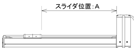
張力測定時のスライダ位置
