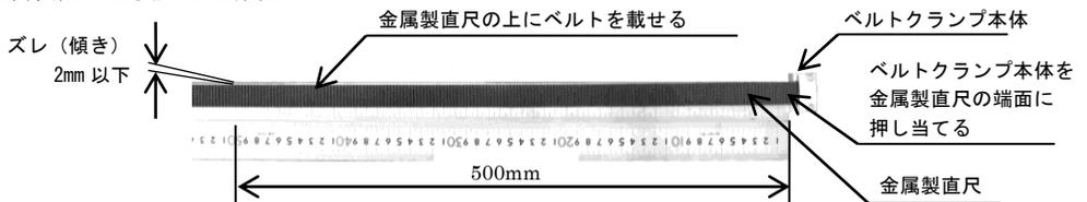
ベルトは真っ直ぐに伸ばして、ベルトの捻れ、曲がりによる誤測定がないように注意してください。
