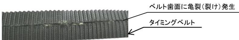
ベルトの歯面に亀裂（裂け）発生状態
