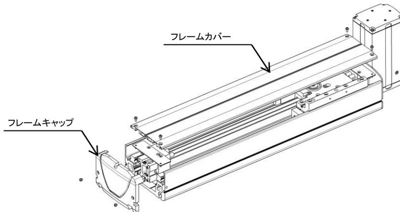
(2) 反モータ側端のベルトクランプ板のボルト 2本を緩め、タイミングベルトの張りを緩めます。
