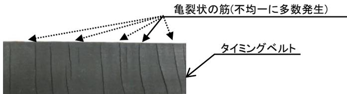
②:寿命中期の亀裂状の筋の状態(タイミングベルト背面)(約 300 万往復動作後(\*1))
