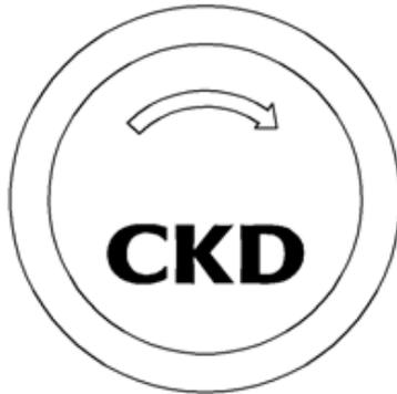
手動ツマミを指でつまみ、矢印方向（時計回り）に回すと通電時と同じ状態となり、指を離すと自動的に非通電時の状態となります。
