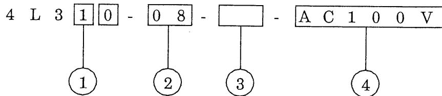
※ 上記形番は、2位置シングルソレノイド、電磁弁接続口径PT1/4、手動ノンロック、定格電圧AC100V。
