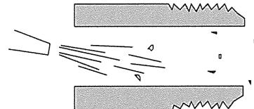
●配管にはシールテープ又はシール剤を用いますが、ネジ先端から2山控えて使用し、管内や機器内部にシール屑やシール剤の残材が入り込まないように気を付けてください。
