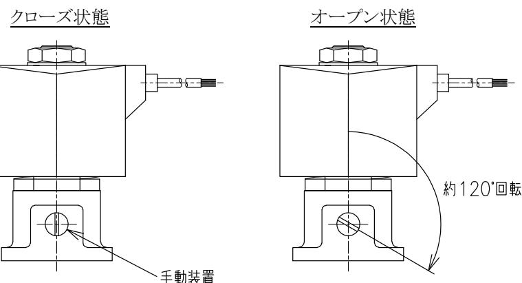
(図4) 手動装置の操作方法
