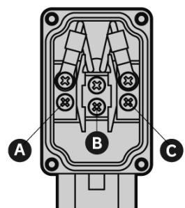
⑤配線完了後、ガスケットが正常に組み付けされていることを確認し、カバーをして、カバー取付ねじを締付トルク0.5N·mで締め付けしてください。
