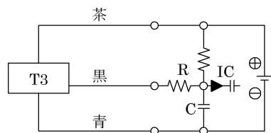
図4 容量性負荷に電流制限抵抗Rを入れた例。
