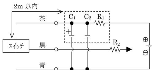
図7・電源ノイズ吸収回路
