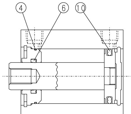
・SSD-  $\phi$  63～ $\phi$  100 (複動・片ロッド形)
