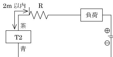
図6・突入電流制限抵抗
