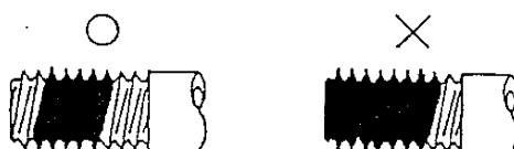
4-7 配管後は石けん水などで接続部の漏れを確認してください。
