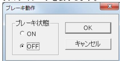
現在のブレーキ状態が表示されるので、変更する場合はON・OFFを選択した後に[OK]ボタンをクリックしてください。
