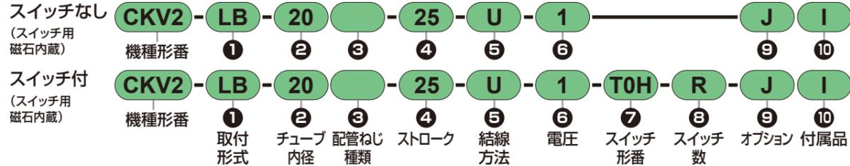
① 取付形式 取付金具は添付して出荷します。ただし、ジャバラ付のLB、FA、TAは組付けて出荷します。
