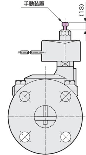
多種流体制御用2・3ポート電磁弁
