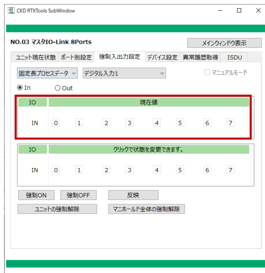
IO-Link マスタユニットの固定長プロセスデータ
