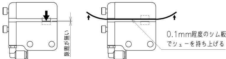
4. 保持用ディスクの上側左右2箇所に0.2mm(または0.15mm)のシム板を下図のように挿入します。
