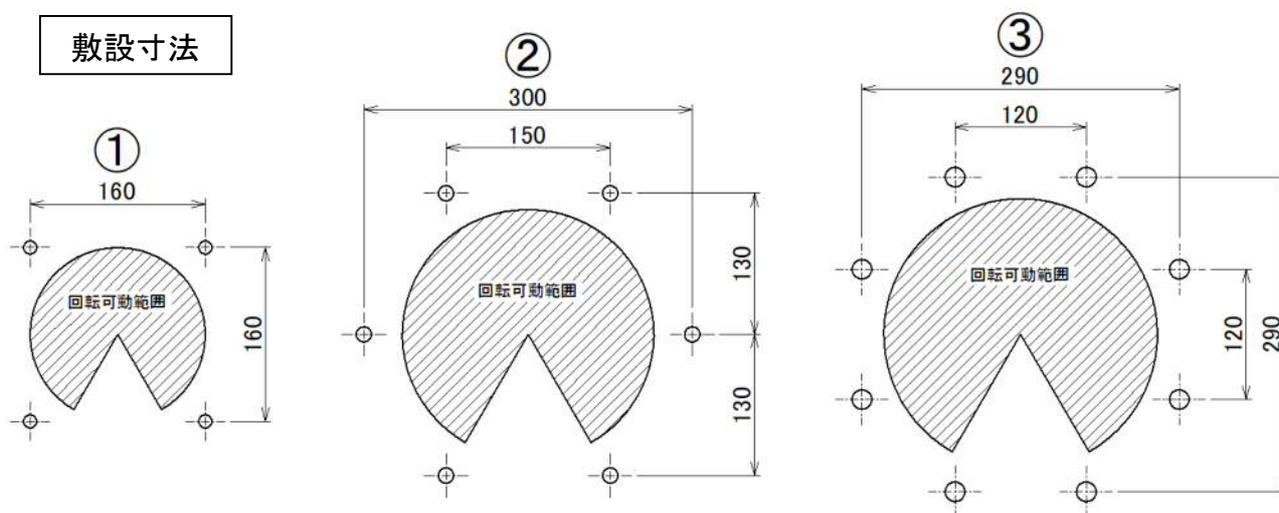
架台や台車などへの取付けには強度区分10.9または12.9のボルトを使用して取付け、1.5D以上のねじ込み深さを確保してください。
