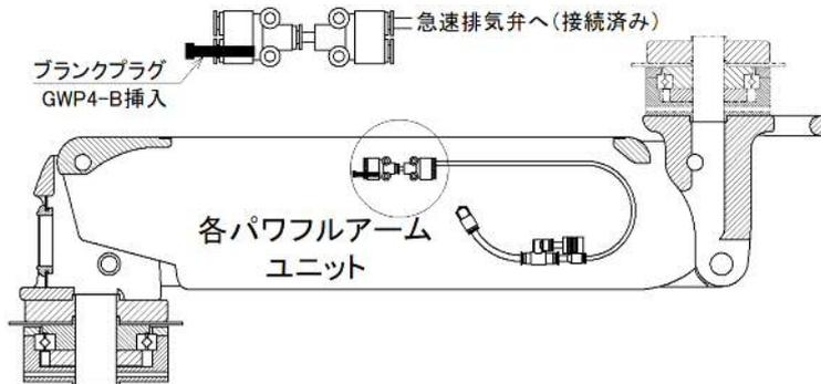
最下軸がスカラアームユニットの場合は、ニュージョイント Y形チーズ GWY44-0を配置し、挿入口1か所にブランクプラグ GWP4-Bを挿入します。
