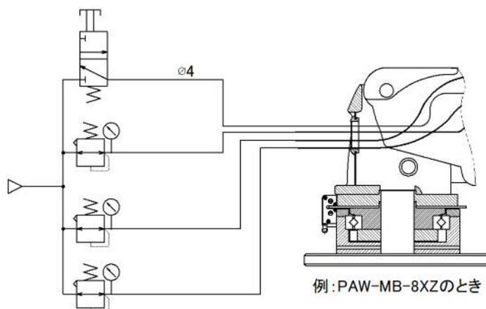
5. 手動切換弁を切り換え、ロックを解除します。
