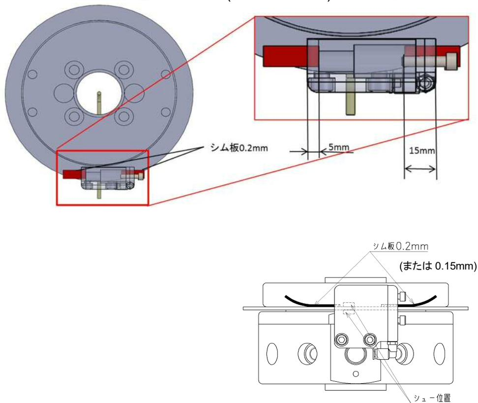
5. 回転ロックユニットを上から軽く押しつけて、保持用ディスクと回転ロックユニットの隙間を均一にした後、仮取付け状態のボルト2本を締付け、シム板を取外します。
