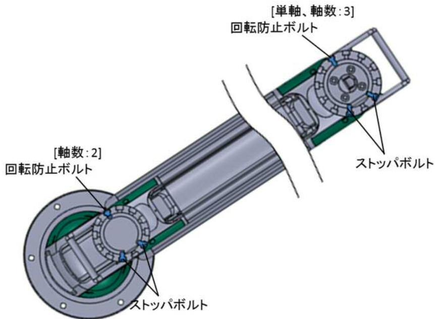
7. ストップボルトを抜き取り、取付プレートを回転させて、2箇所ずつ付属のボルト、ワッシャを締付けます。
