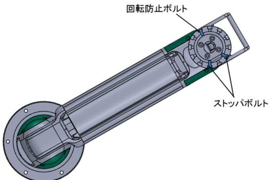
3. ストップボルトを抜き取り、取付プレートを回転させて、2箇所ずつ付属のボルト、ワッシャを締め付けます。
