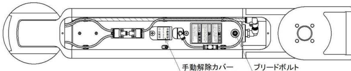
5. 上面にある黄色でマーキングされているブリードボルトを2～3回転緩めます。
