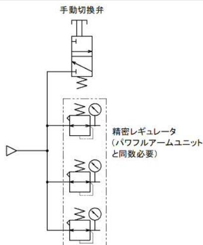
4. 最下軸より出ているロック解除用配管( $\phi 4$ チューブ)を手動切換弁に、各シリンダ用配管( $\phi 8$ 、 $\phi 10$ チューブ)をそれぞれ精密レギュレータに接続します。
