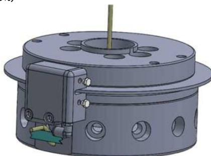
6. 回転ユニットに仮固定されているφ4 チューブを、ニュージョイント継手に挿入します。
