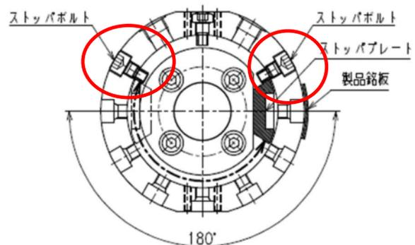
**ポイント** 複数軸(特に 3 軸以上)では、最下部以外の回転ユニットの回転角度は 180° 以内に規制することを推奨します(軸の動きをコントロールしやすくなります)。
