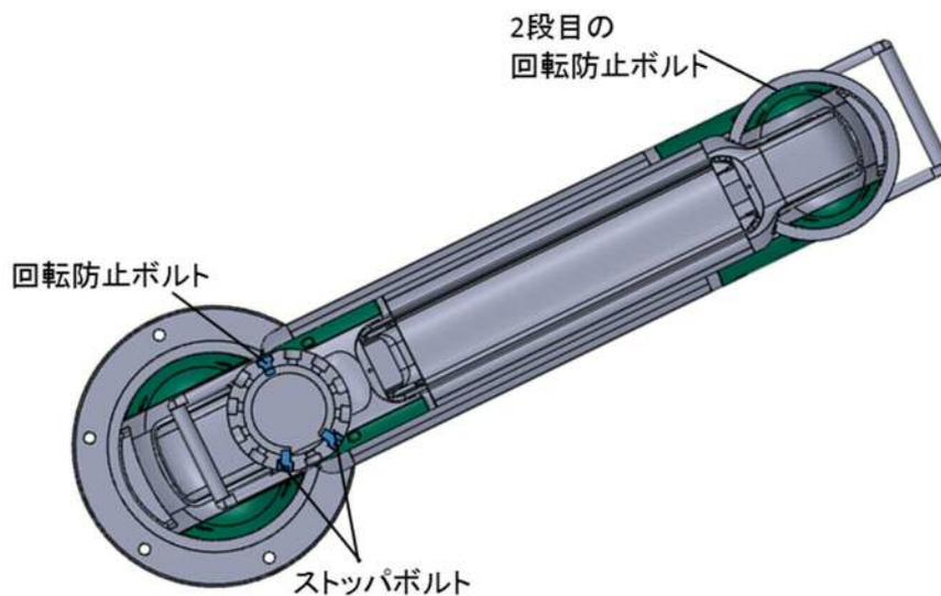
3. ストップボルトを抜き取り、取付プレートを回転させて、2箇所ずつ付属のボルト、ワッシャを締付けます。
