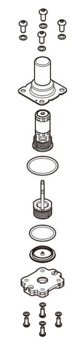
注1：材質：A (アルミ、NBR) の場合、構成部品⑬皿ばね座金と⑭六角穴付ボタンボルトの数量が(2)になります。
