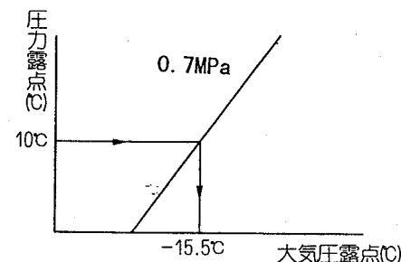
上記表の見方により、圧力 **0.7MPa** の時圧力露点 **10°C** を大気圧露点に変換しますと **-15.5°C** となります。
