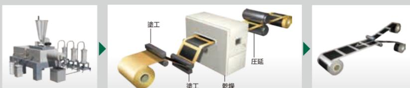
4 計量・混練 正極材・負極材の適正量を量り、材料ごとに混ぜあわせペースト状にします。
