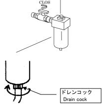
3) ボウルガードのラッチを押えて 45° ほど右に回し、下側に引くとボウル組立が外れます。 Bowl assembly comes down when it is pulled after turning it clockwise for approx.45 degrees while holding latch of bowl guard pressed.
