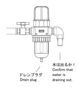
▶ドレン排出インターバルの調節使用条件(使用圧力など)により ドレン量が変化しますので、オートドレントラップのニードル バルブにて排出インターバルを調節してください。調節の目安は、 外から見てボウル内の水面が見える程度です。(ボウルが水で満杯 にならないこと)インターバルが短すぎるとエアのロス量が多く なり、逆に長すぎるとドレンが溜まってしまいます。 なお、ニードルバルブを「+」の方向に回しますとインターバルが 短くなり、「一」の方向に回しますとインターバルが長くなります。
