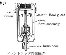
ドレントフッフ内部構造 Inside structure of drain trap
