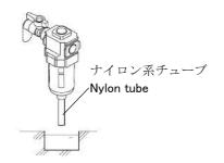
内径 $\phi$ 5.7 $\sim$  $\phi$ 6.0 (外径 $\phi$ 8) のナイロン系チューブ をご使用ください。長さは 5m 以内で、かつ立ち上が り配管はさけてください。
