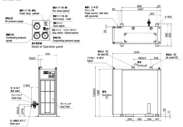
注記 Note 1.ドレントラップ、ボールパルブは添付品です。 1.Drain trap and Ball valve are accessories.
