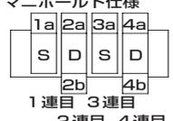
1連目 3連目<br>2連目 4連目       |                  |             | 標準配線 (順詰め)：無記号<br>コネクタピンNo. 1 2 3 4 5 6<br>バルブソレノイドNo. 1a 2a 2b 3a 4a 4b                                                                   |                               | ダブル配線：W<br>コネクタピンNo. 1 2 3 4 5 6 7 8<br>バルブソレノイドNo. 1a 空 2a 2b 3a 空 4a 4b |                               |
