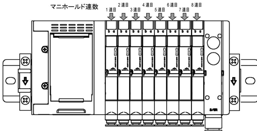
本図は、子局 N4E0-T7EN1 でダブルソレノイドタイプの電磁弁を8連分搭載したときのものです。
