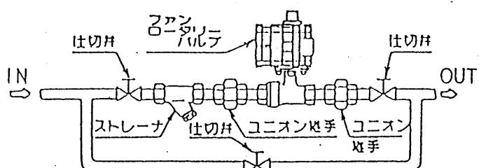
保守点検を、しやすくする為にユニオン継手または、フランジ継手の使用とバイパス管を設けて下さい。
