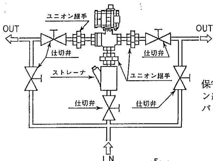
保守点検を、しやすくする為にユニオン継手または、フランジ継手の使用とバイパス管を設けてください。
