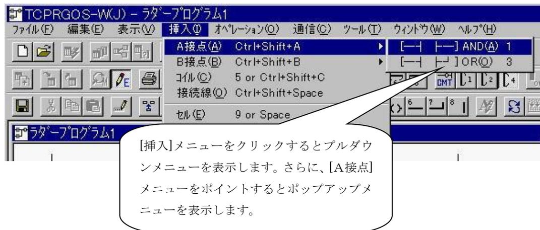
② カーソルの位置にA接点のシンボルが入力され、接点アドレス入力のダイアログボックスが表示されます。
