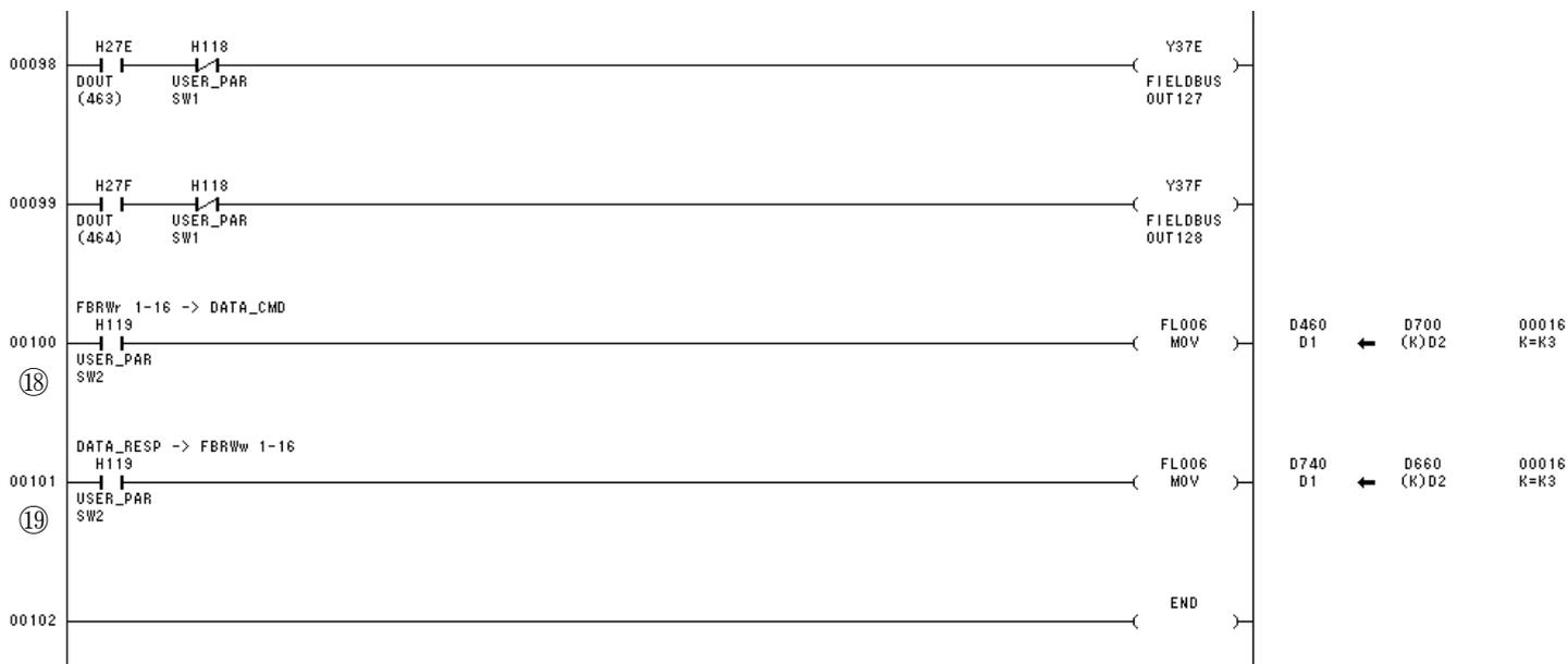
⑱H119 が ON のとき、データレジスタ領域 FBRWr1~16(D700~D70F)のデータをコマンドセットレジスタ DATA\_CMD(D460~D46F)に転送します。
