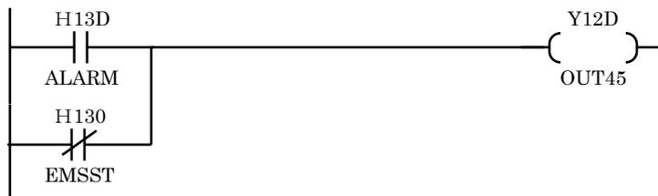
ALARM(H13D)信号は、アラーム発生時に ON します。しかしながら、非常停止押しボタンが ON の状態 (8-014 が発生) が ON している時は故障信号が ON しません。EMSST の状態も監視することでアラームが発生している、または非常停止ボタンが押されている状態を出力できます。
